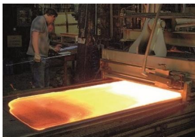
Εικόνα 4 Παραγωγή επίπεδου γυαλιού με τη μέθοδο «cast on table» (Πηγή: https://www.buildingconservation.com/articles/histwindowglass/histwindowglass.html )
