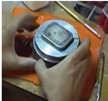
Παντέφι με το καλούπι σιλικόνης και δεξιά κλειστό έτοιμο για τη λαστιχιέρα.
