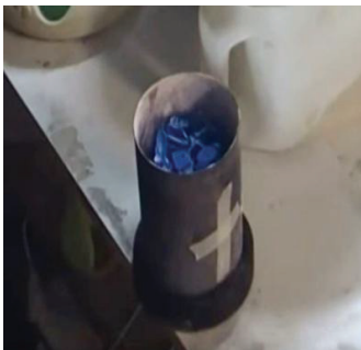
Μούφλο με το «δεντράκι» και γεμάτο με το μείγμα του γύψου.
