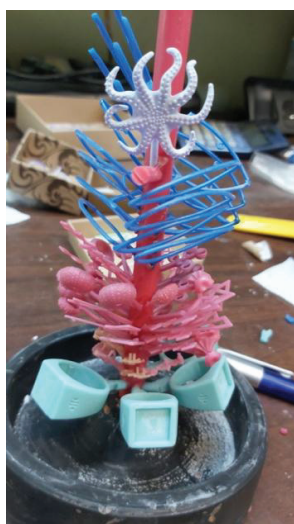
Δεντράκι αριστερά με πολλά κέρνα μοντέλα πριν την αποκέρωση και δεξιά μετά τη χύτευση του μετάλλου Πηγή: Συγγραφική ομάδα
