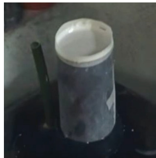
Μούφλο με το «δεντράκι» και γεμάτο με το μείγμα του γύψου.
